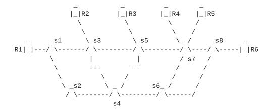
Routed path: R1-(s1-s3)-R2-(s3-s5)-R3-(s5-s7)-R4-(s7)-R5-(s7-s8)-R6 Shortcut: R1-(s1-s2-s4-s6-s8)-R6
