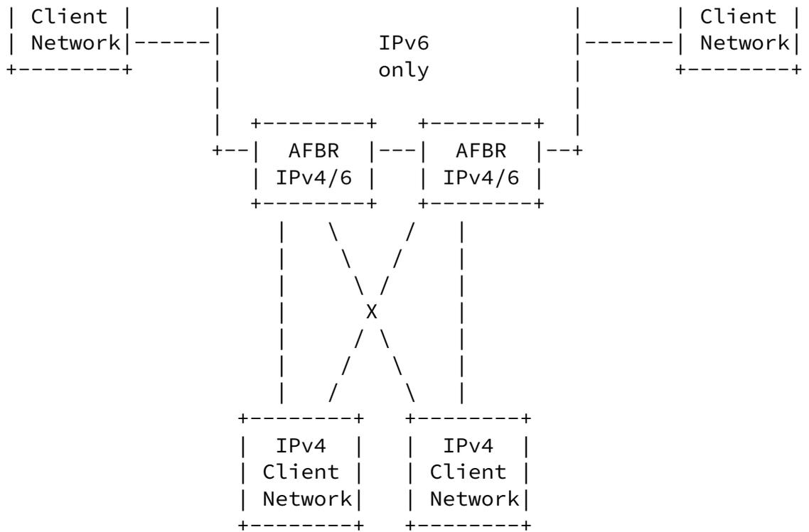
Figure 6: 4to6 Software - IPv4 Edge over an IPv6-Only Core
