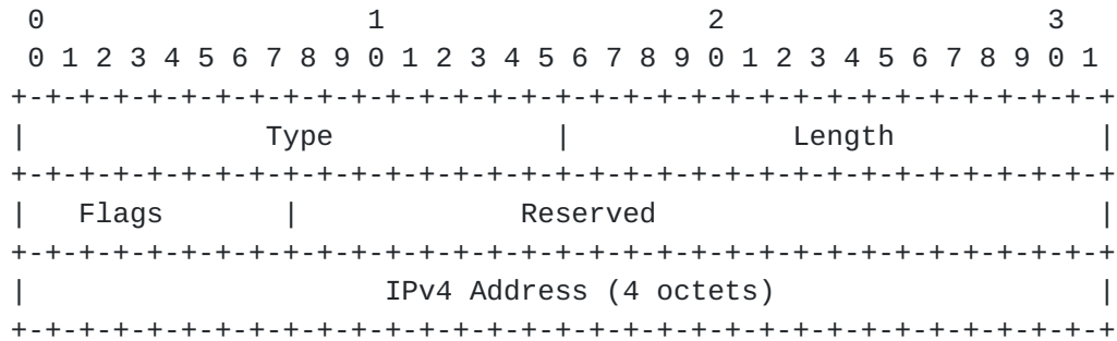
IPv4 ERO sub-TLV format
