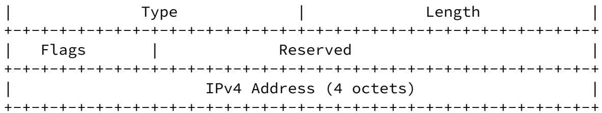
IPv4 Backup ERO TLV format
