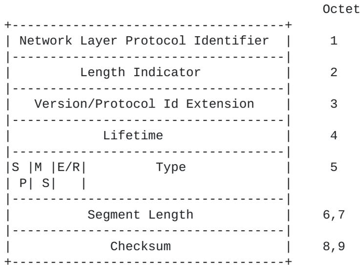
Figure 7-2. PDU Header--Fixed Part
