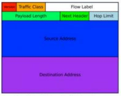
An IPv6 Packet Header
