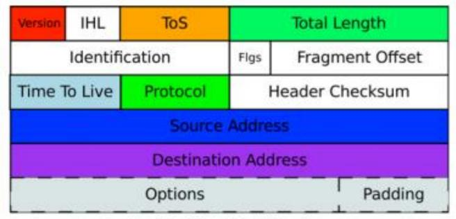
An IPv4 Packet Header
